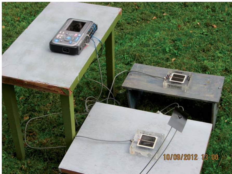
Joonis 1. Kogu- ja hajukiirguse sünkroonne mõõtmine Figure 1. Recording the global radiation and its diffuse fraction
