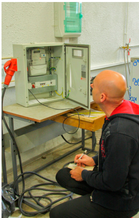
Joonis 3. Energiakulu mõõtmiseks kasutati tööstuslikku energiaarvestit (Foto autor Kaspar Dobrus) Figure 3. Measuring energy with industrial energy meter (Photo Kaspar Dobrus)
