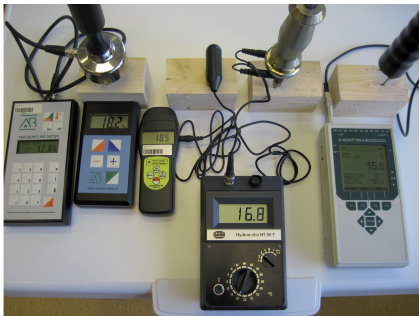
Joonis 1. Katsekehade niiskussisalduse mõõtmiseks kasutatud niiskusemõõtjad. (Foto: Tamme, 2012) Figure 1. Moisture meters used in the experiment for measuring the moisture content in specimens. (Photo: Tamme, 2012)
