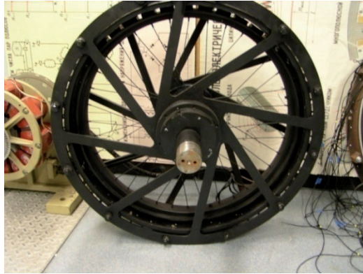
Joonis 4. Projekteeritud generaatori prototüüp NdFeB-magnetitega Figure 4. Prototype machine with NdFeB magnets
