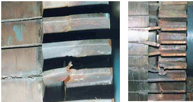
Joonis 1. Ülekoormuse tõttu purunenud rootorivardad (Fišer ja Lavric 2008). Figure 1. Broken rotor bars due to heavy duty operation (Fišer and Lavric 2008).
