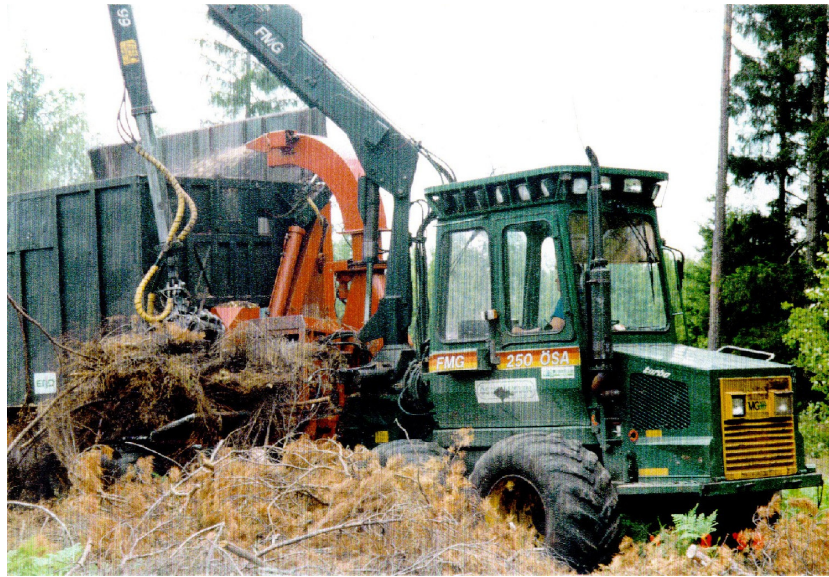
Joonis 3. Iseliikuv käruga puiduhakkur töö Saaremaal metsas
