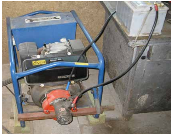
Joonis 2. Honda mootoriga diislegeneraator (4,5 kW), millel on akutoitega käivitusstarter
