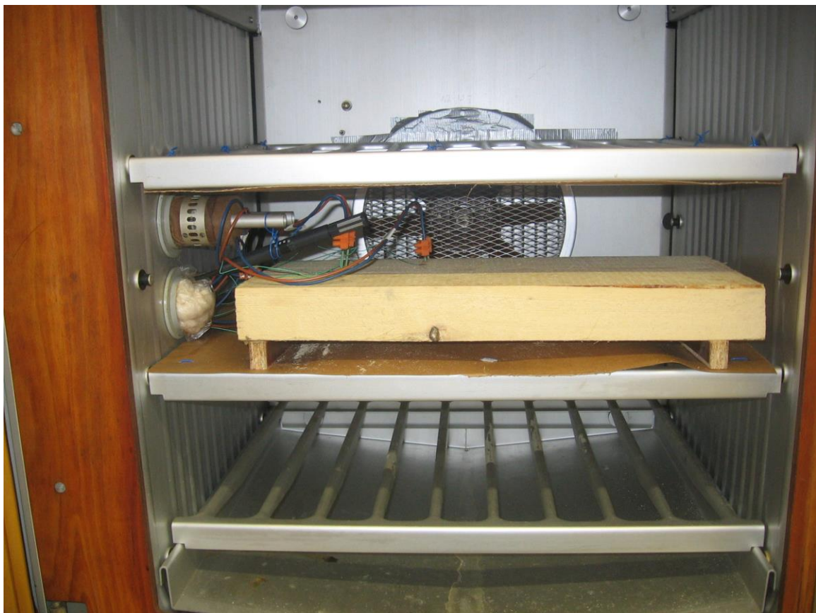
Joonis 4. Kliimakambri FEUTRON tööruumala sisevaade. (V. Tamme foto).
