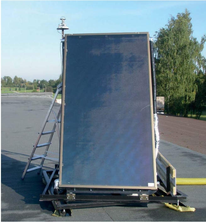
Joonis 1. Päikesekollektori eestvaade. Ülal vasakul on näha päikesekiirguse andur, paremal klaasi alt „kumab“ heleda joonena klaasialuse temperatuuri andur. Figure 1. Solar collector from front view.
