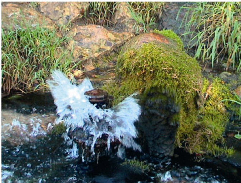
Joonis 3. Töötav vesioinas Tindioru talus
